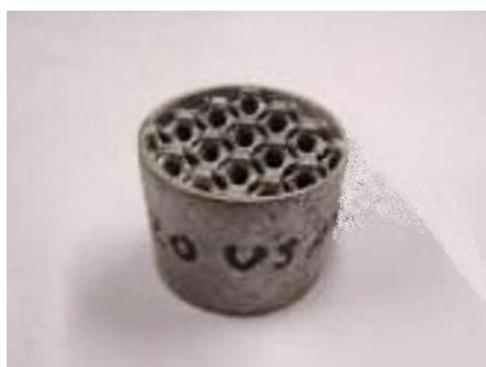
**Figura 3.12.** Provede de espuma US20% com parede.
