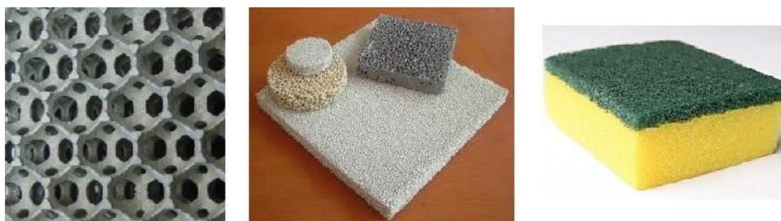
**Figura 2.1.** Exemplos de espumas (metálica, cerâmica e polimérica).
