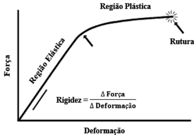
**Figura 8** - Curva força – deformação de um material elástico (Knudson; 2007)
