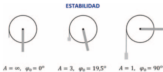
Figura 5. Tres situaciones de equilibrio estable; a la derecha se tiene la situación límite.
