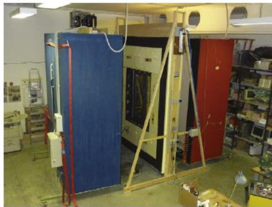
Figura 2.2 - Perspectiva geral de uma hotbox (Asdrubali & Baldinelli, 2011).
