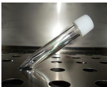
Figura 9 - Amostra em incubação na estufa a 37°C num suporte com uma inclinação de 30°, durante o SU.
