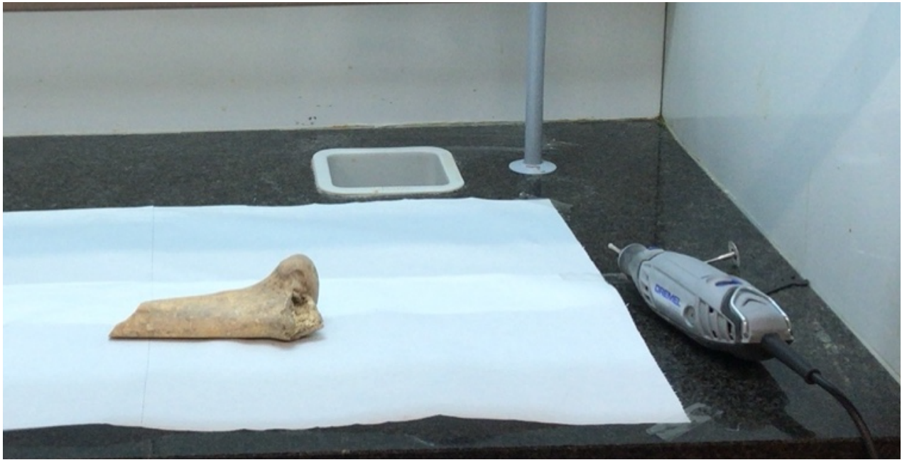
Figura 2.1. Material utilizado (Dremel 3000) para corte e limpeza dos fragmentos de ossos selecionados para análise de isótopos na HOTTE.
