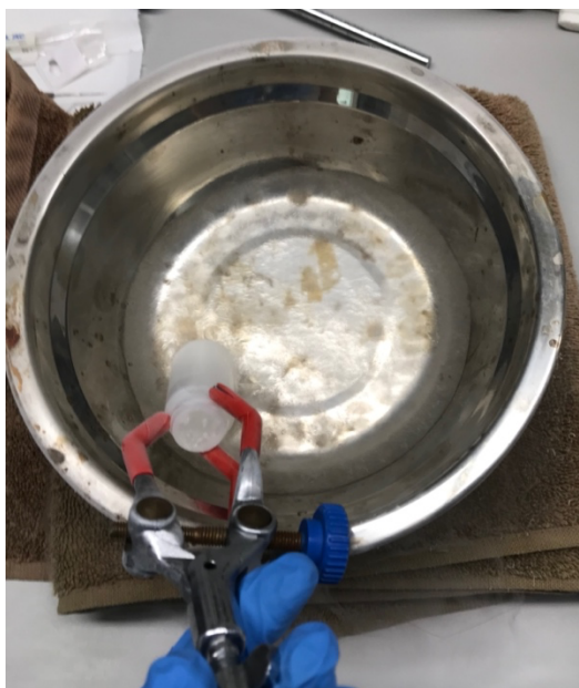
Figura 2.5. Congelação com azoto líquido das amostras em frascos para a liofilização.
