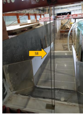
Figura 4.11 – Localização da sonda S8 no topo da superestrutura.
