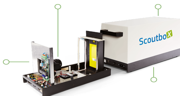
Figura 9 – Sistema automático de monitorização de armadilhas pegajosas amarelas (AgroCares, 2020).
