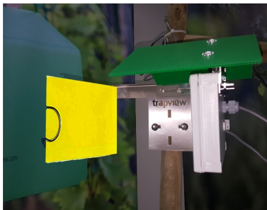
Figura 8 – Sistema automático de monitorização de armadilhas pegajosas amarelas (Trapview, 2020).
