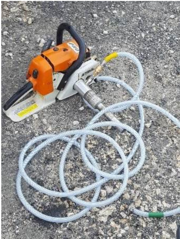
Figura 24. Perfuradora manual, alimentada a gasolina, e com um sistema de arrefecimento com água.
