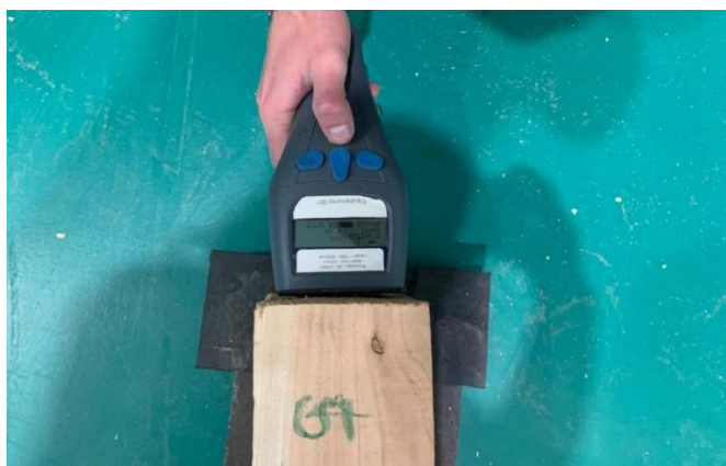
Figura 11 – Ensaio dinâmico com a utilização do Timber Grader MTG.
