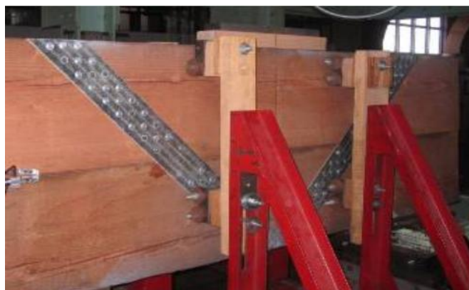
Figura 4 – Utilização do método MF-FRP em vigas de madeira (Schorer et al., 2008).
