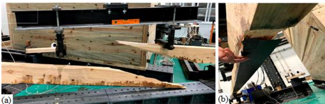
Figura 20 – Rotura logo após o reforço de FRP (a) e detalhe da rotura (b) (grupo 4).
