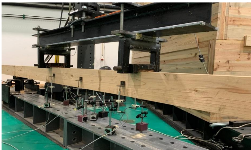
Figura 12 – Layout de ensaio para avaliação do módulo de elasticidade local e global.
