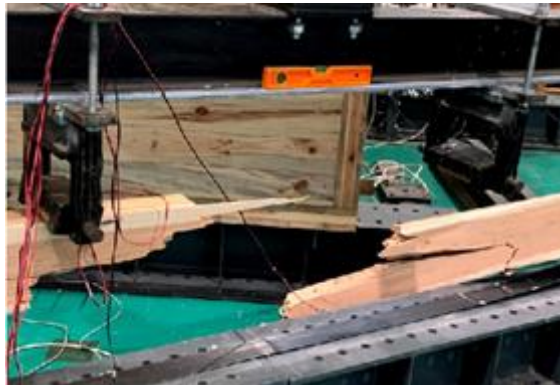
Figura 17 – Rotura da ligação adesivo/FRP (grupo 1).
