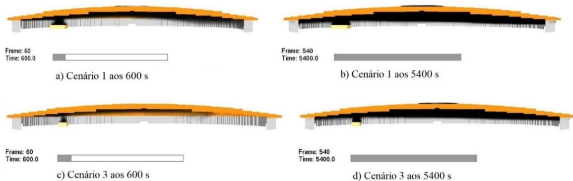
Figura 2.12 - Previsão de distribuição de fumo e gases para os cenários 1 e 3 da simulação do centro de exposições de Taiyuan (adaptado de [12])
