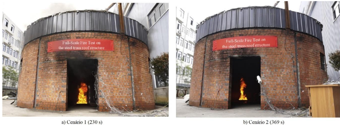
Figura 2.39 - Aspeto do ensaio para o Cenário 1 e 2 no momento do registo do altura máxima de chama (adaptado de [29])
