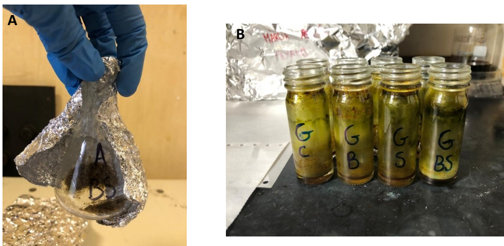
Figura 8 - Erlenmeyer com folhas de oliveira trituradas para extração de compostos fenólicos e lipofílicos (A) Frascos com sobrenadante para obtenção do extrato (B)
