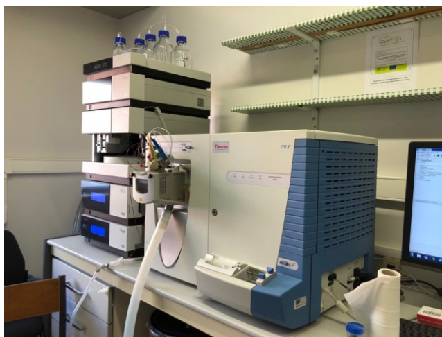
Figura 10 - Equipamento de cromatografia líquida Thermo Scientific Ultimate 3000RSLC equipado com um detetor de matriz de diodo DionexUltiMate 3000 RS acoplado a um espectrômetro de massa
