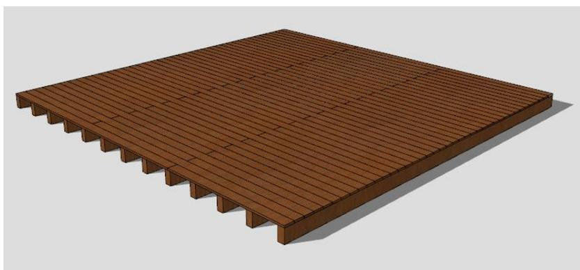
Figura 3.2 - Modelo 2: Soalho contínuo com ligação a um terço do vão ou dois terços do vão, em quincôncio.
