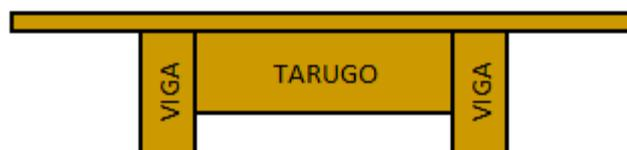
Figura 4.9 – Secção modelo de soalho sobre vigas com tarugos.
