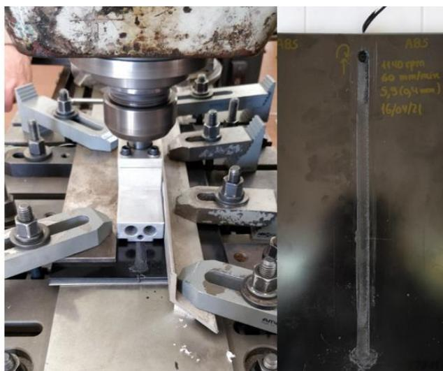
**Figura 13.** Realização de uma soldadura.
