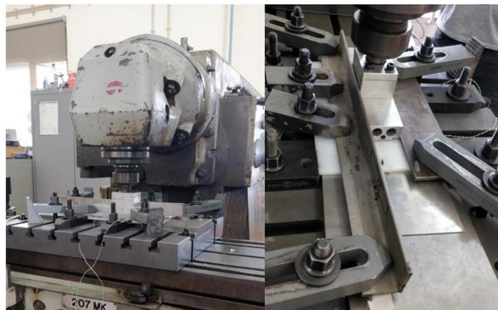
**Figura 12.** Sistema de fixação para realizar as soldaduras.
