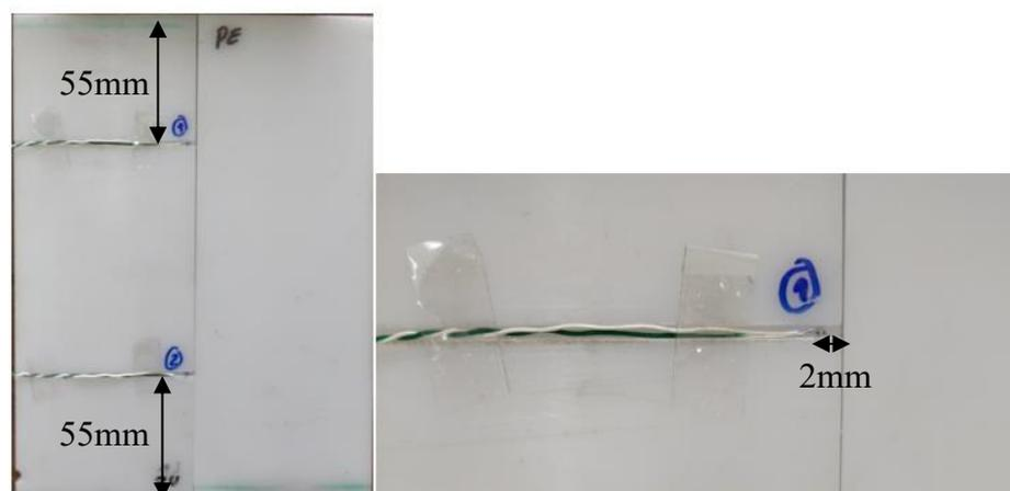
**Figura 10.** Placas preparadas, com os termopares inseridos.
