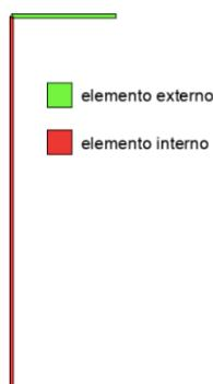
Figura 2-14 – Representação de separação em elementos externos e internos de um perfil U.
