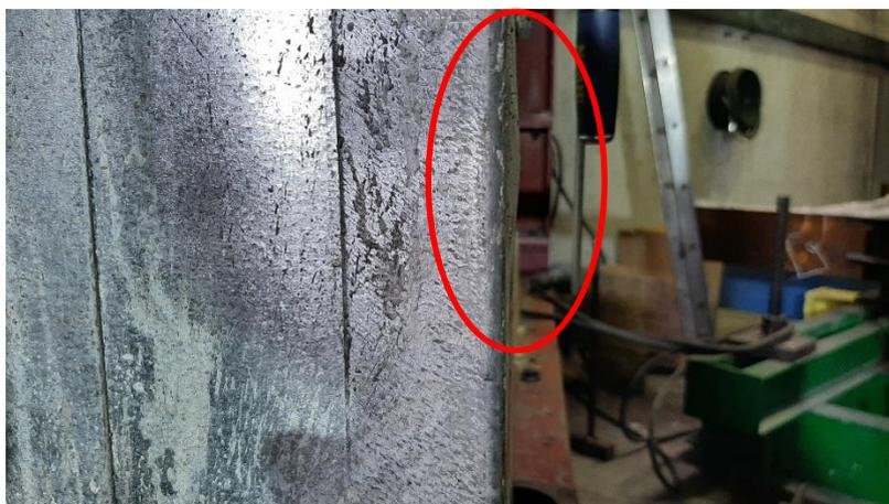
Figura 4-16 - Encurvadura local na extremidade do provete 2.
