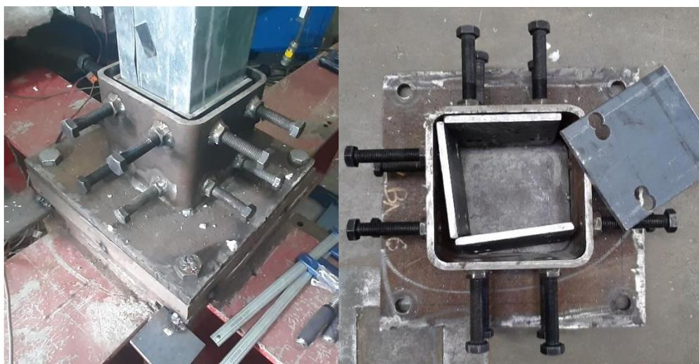
Figura 3-11 – Sistema de apoio semirrígido
