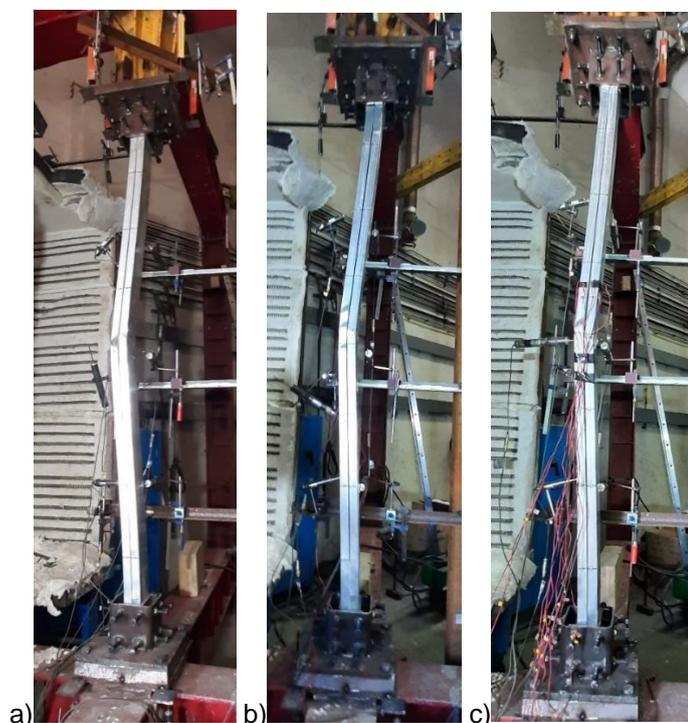
Figura 4-2 – Modos de rotura dos provetes R\_2C+2U. a) provete 1. b) provete 2. c) provete 3.
