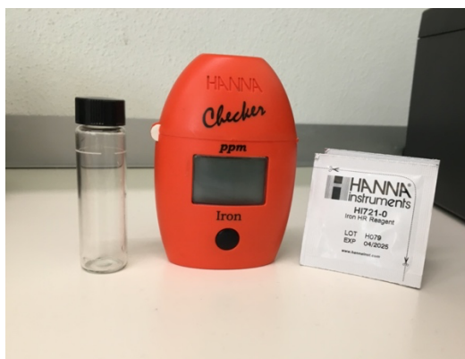
Figura 4.2. Fotómetro e reagente necessários para a determinação da concentração de ferro total nas amostras de efluente.
