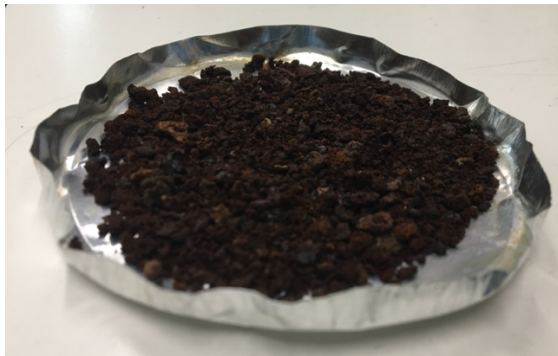
Figura 5.15. Catalisador polyfenton utilizado nos ensaios de ozonólise catalítica heterogénea.
