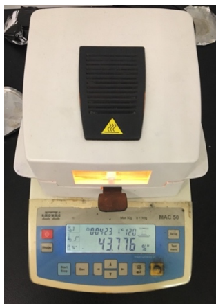
Figura 4.3. Equipamento utilizado para a pesagem e secagem dos filtros necessários à medição dos SST.
