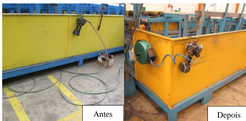
Figura 6.4. Novo sistema de fornecimento de ar-comprimido à máquina de cintar.
