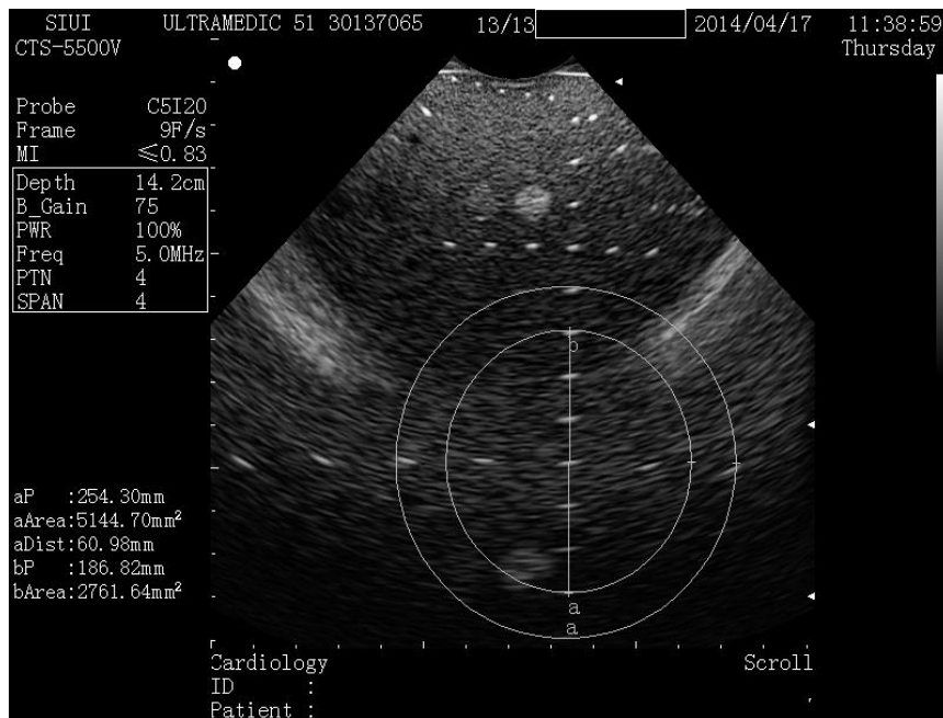
Figura 34- Exemplo de imagem para determinação da exatidão do sistema de medição na profundidade de 9 cm.
