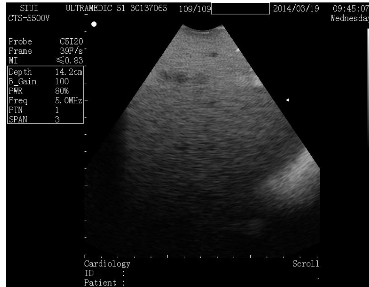
Figura 35- Exemplo de imagem para avaliação da uniformidade da imagem com uma zona focal
