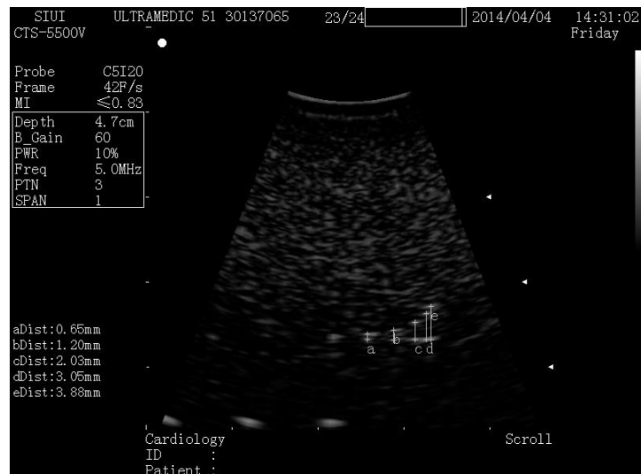
Figura 14- Exemplo de imagem para determinação da Resolução Axial na profundidade de 3,0 cm.
