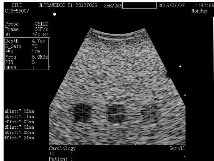
Figura 17- Exemplo de imagem para determinação do contraste de detalhe - 1ª Medição dos alvos (-9 dB, -6 dB e -3 dB) na profundidade de 3 cm.
