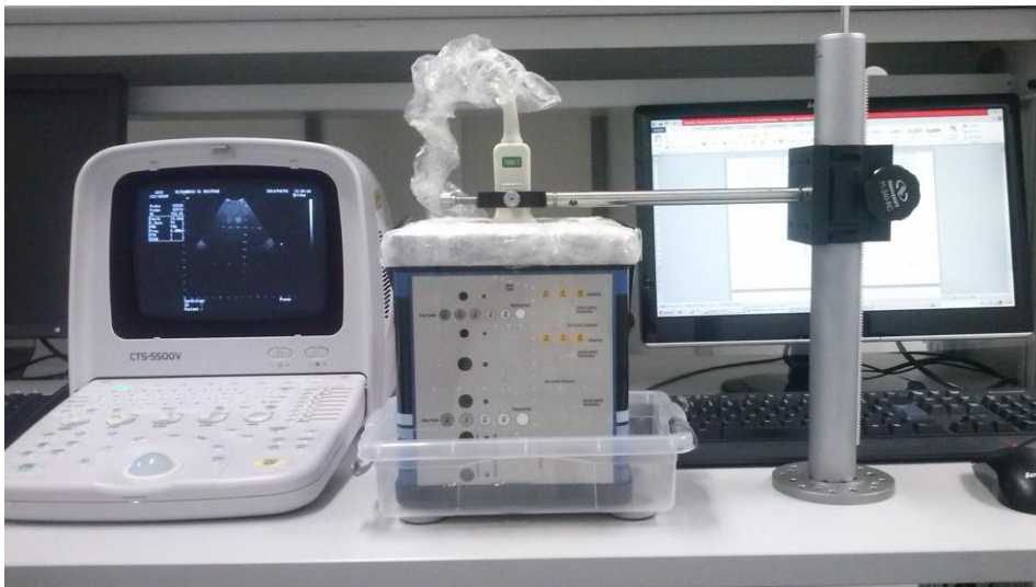
Figura 9- Montagem experimental para aquisição das imagens, composto pelo equipamento de ultrassom, o phantom e o sistema de posicionamento.
