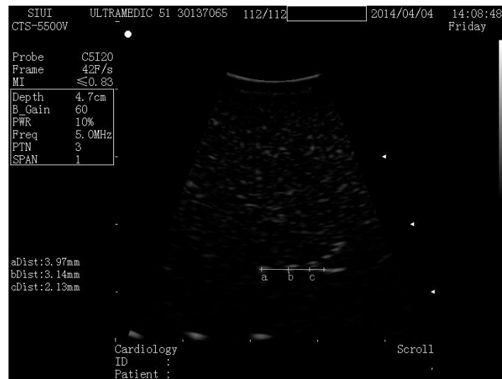
Figura 13- Exemplo de imagem para determinação da Resolução Lateral na profundidade de 3,0 cm.
