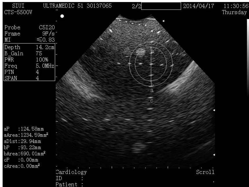
Figura 33- Exemplo de imagem para determinação da exatidão do sistema de medição na profundidade de 4 cm.
