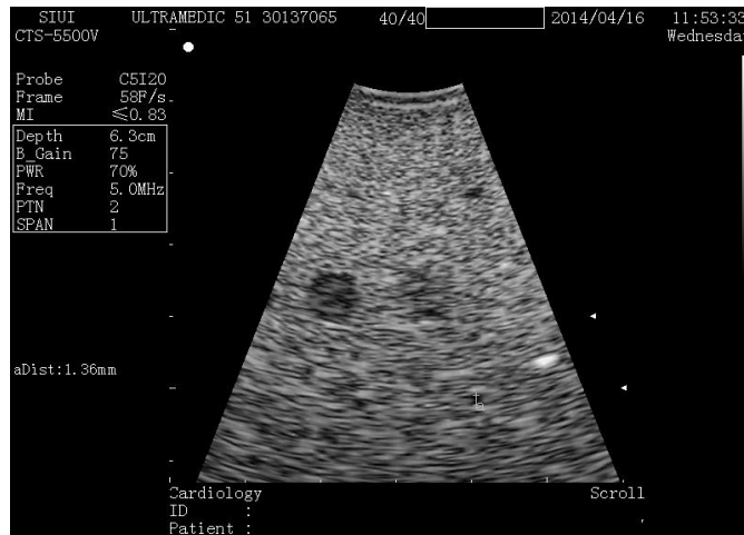
Figura 21- Exemplo de imagem para determinação do vácuo esférico na profundidade de 6,5 cm.
