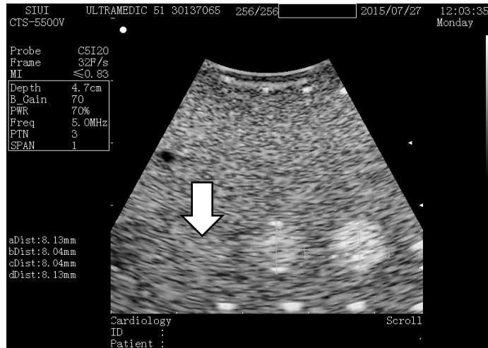
Figura 18- Exemplo de imagem para determinação do contraste de detalhe - 1ª Medição dos alvos (+6 dB e +15dB) na profundidade de 3 cm (A seta branca indica o local onde deveria estar o alvo com 3 dB).
