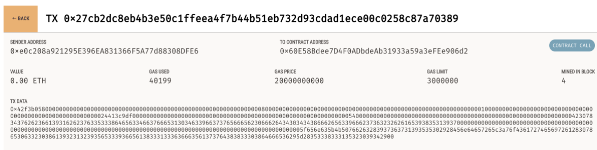
Figura 30 – Registo da transação encriptada com a chave pública do Banco Central na blockchain .
