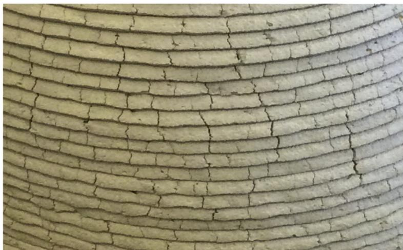
*Figura 3.1 - Exemplo de fendilhação por retração da argamassa impressa em 3D (Foto: De Schutter, G. et al., 2018).*
