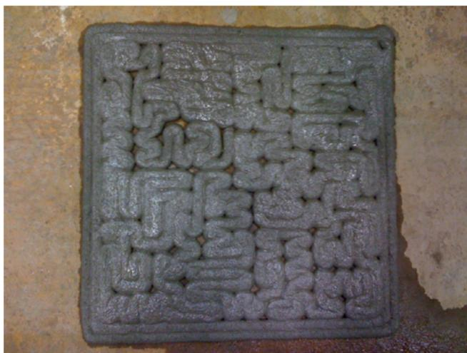
*Figura 3.7 - Chochos devido a mudança de direção do bocal da impressora 3D (Foto: Buswell, R. A. et al., 2018).*
