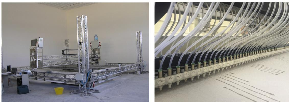
Figura 5.2 - Impressora 3D modelo D-Shape na esquerda e a cabeça desta e seus bocais na direita (Foto: Lowke, D. et al., 2018).
