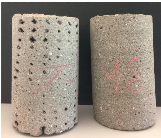
*Figura 3.6 - Chochos na amostra da esquerda, onde os filamentos podem ser facilmente identificados e uma amostra de boa qualidade na direita, onde os filamentos são indiscerníveis (Foto: Buswell, R. A. et al., 2018).*
