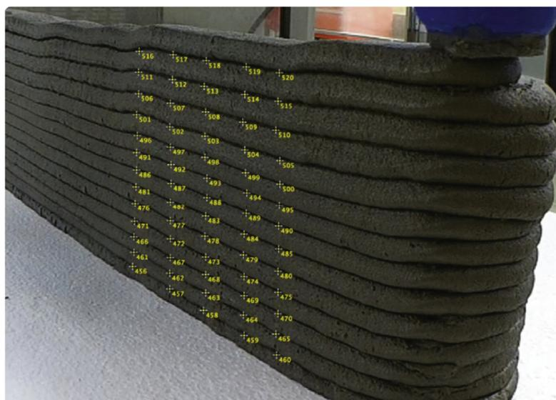
Figura 3.4 - Deformações das camadas devido ao ciclo de deposição (Foto: Buswell, R. A. et al., 2018).
