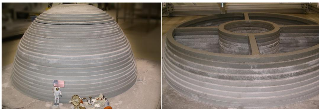
Figura 5.8 - Protótipo de um habitat lunar construído em laboratório (Foto: Contour Crafting Corporation, 2017).
