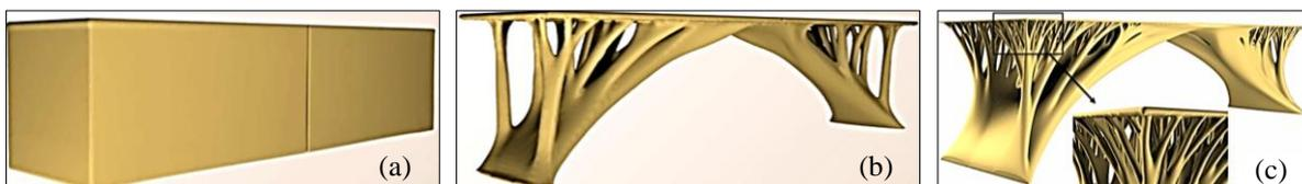
Figura 3.1 – Influência da malha de elementos finitos, na otimização topológica. Exemplo de uma ponte.
