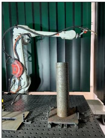
Figura 6.1 – CHS impresso com 500 mm, por WAAM – CMT.
