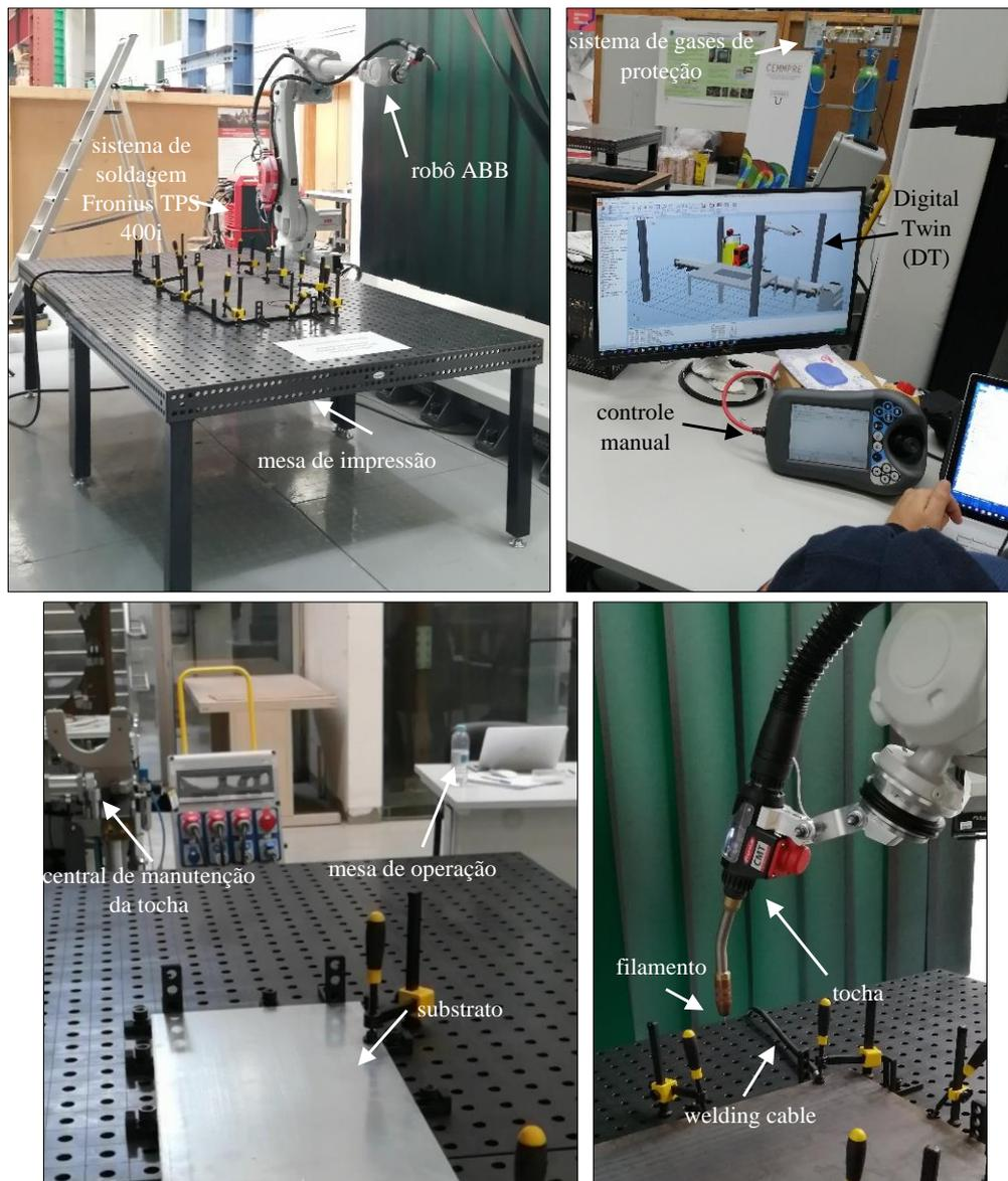
Figura 4.2 – Estrutura laboratorial para a categoria DED-WAAM.
