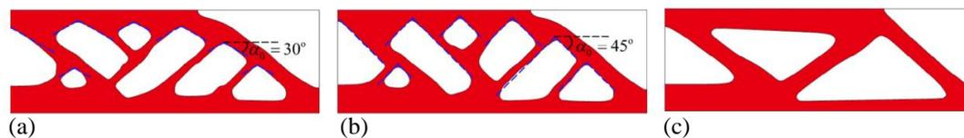
Figura 3.6 – Resultado da otimização de uma viga com restrição de *overhang*
