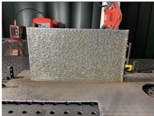
Figura 6.2 – Parede impressa com 480 x 300 x 6 mm, por WAAM – CMT.
