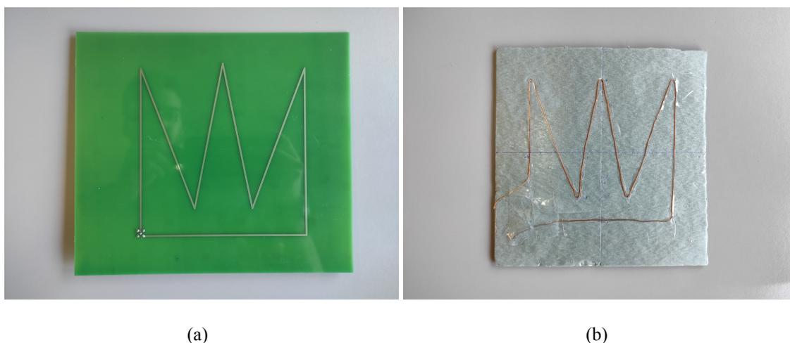
**Figura 4.6:** Imagens das duas antenas fabricadas a) Versão 1 da antena em coroa, impressa numa placa de dielétrico e b) Versão 2 da antena em coroa, composta por um fio de cobre, embutida numa placa de XPS.
