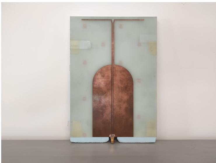
**Figura 4.8:** Antena dipolo padrão utilizada.
