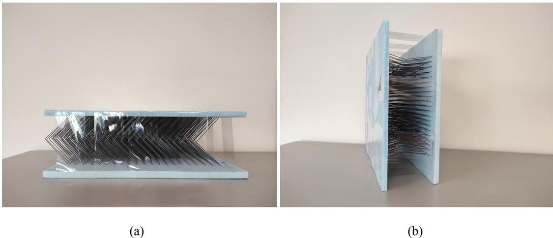
**Figura 4.5:** Imagens da lente metamaterial fabricada embutida em duas placas de XPS: a) Vista de cima, b) Vista em perspetiva.
