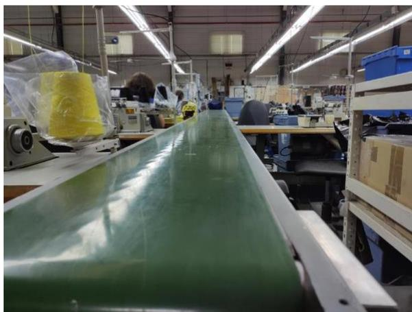
Figura 5 - Célula de fluxo contínuo na secção de costura.
