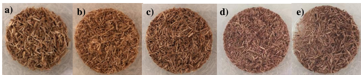
Figura 4.10 - Resíduo sólido resultante da dissolução da madeira usando ChCl+ácido oxálico a 60°C nos tempos de reação de 1h a), 2h b), 4h c), 8h d) e 24h e).
