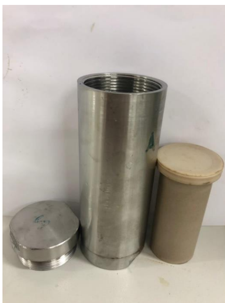
Figura 3.3. Mini-Reactor usado nos testes de dissolução da madeira com líquido iónico e solventes eutéticos.
