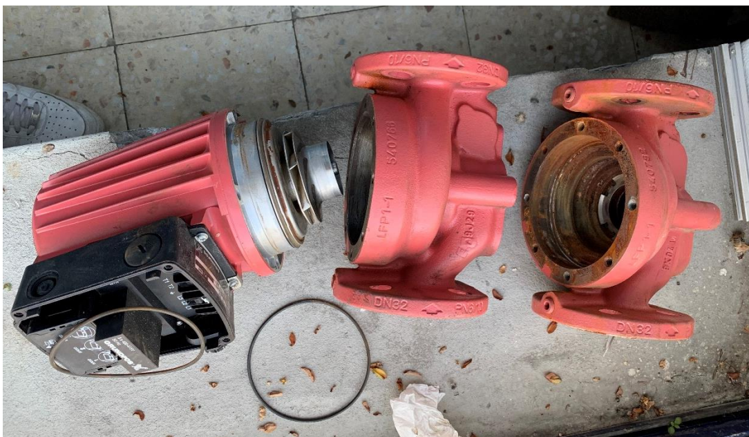
Figura 4.5 Bomba de circulação proveniente do GTA IV, encaixe da bomba novo e encaixe de bomba substituído.
