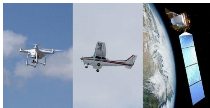
Figura 16 - Representação das três plataformas de aquisição de imagens digitais (drone, avião e satélite) que compõem as especializações das fotogrametria digital. A fotogrametria a curta distância, aqui representada pelo drone, para levantamentos em que a distância entre a câmera e o
