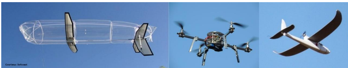
Figura 19 - Exemplo dos três tipos de VANTs mais comuns balões, multirottores e asa fixa, respectivamente. (Fonte: Rodrigues, 2014, fig 1 15 ).
