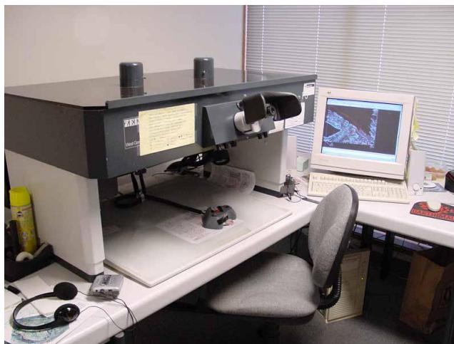
Figura 14 - Restituídor Analítico modelo Zeiss P3. (Fonte: Zeiss, 2018).
