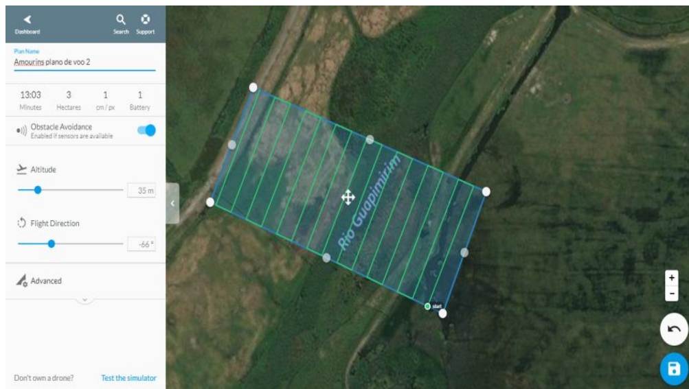
Figura 26 - Exemplo de um planejamento de voo realizado através do Software Drone Deploy para a área do sambaqui Amourins - RJ.
