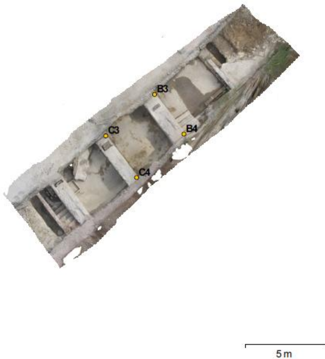
Figura 61 - Ortofoto da estrutura BRT201, trecho sul da estrutura portuária, Charitas, Niterói. Nesta imagem aparecem os pontos usados para georreferenciação do modelo.
