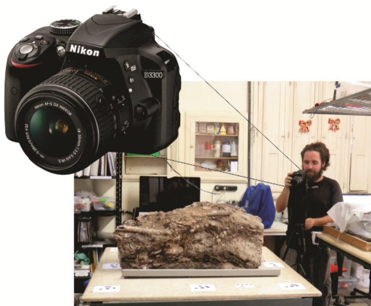
Figura 20 - A esquerda imagem da Nikon D3300 utilizada para fazer os levantamentos fotogramétricos (Fonte: Nikon, 2018). A direita exemplo de levantamento do bloco de sambaqui de Amourins através de câmera estabilizada por tripé (Fonte: foto Bezerra, 2017).
