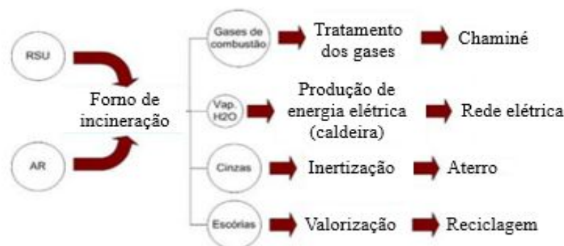
Figura 8– Esquema do processo de incineração com valorização energética
