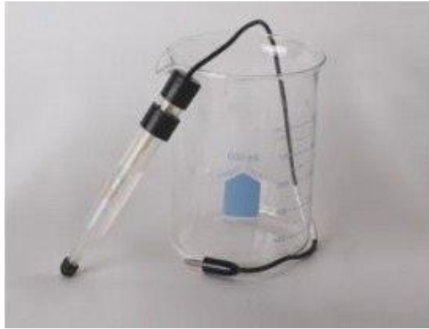
شکل ۲-۳ شمایی از الکتروود مرجع
