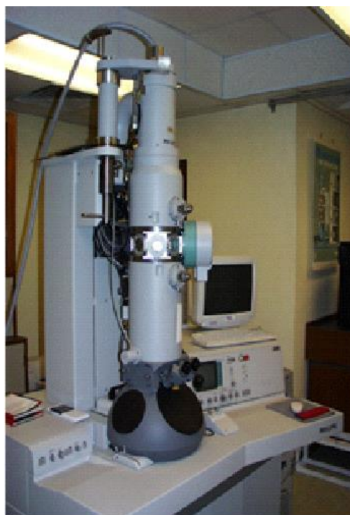
شکل ۱-۵ شمایی از میکروسکوپ الکترونی عبوری و اجزای تشکیل دهنده آن
