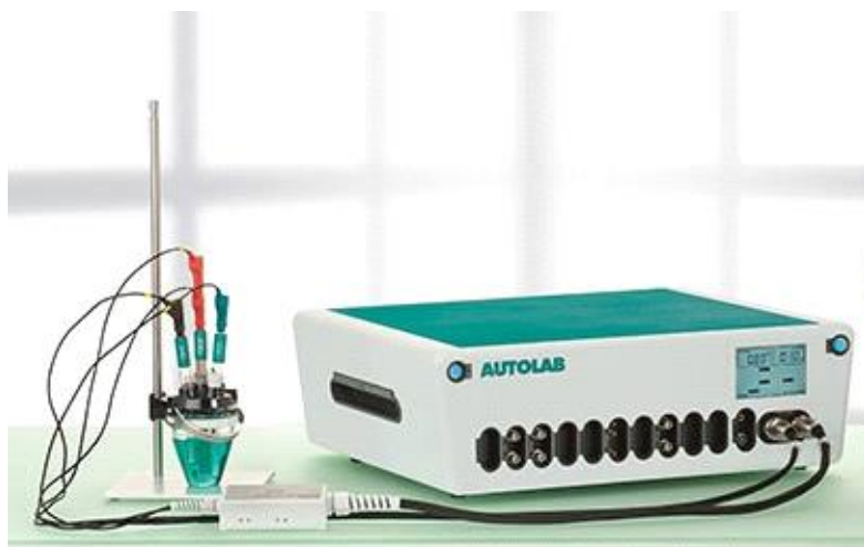
شکل ۱-۲ شمایی از یک سل سه الکترودی در کنار دستگاه اتولب
