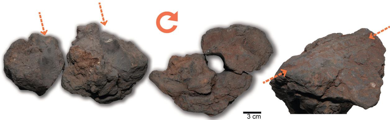
Figura 6 - Agulheiro pertencente ao Forno 3 da Pedrulha, apresenta possíveis marcas de material perecível e manchas de carbonização.
