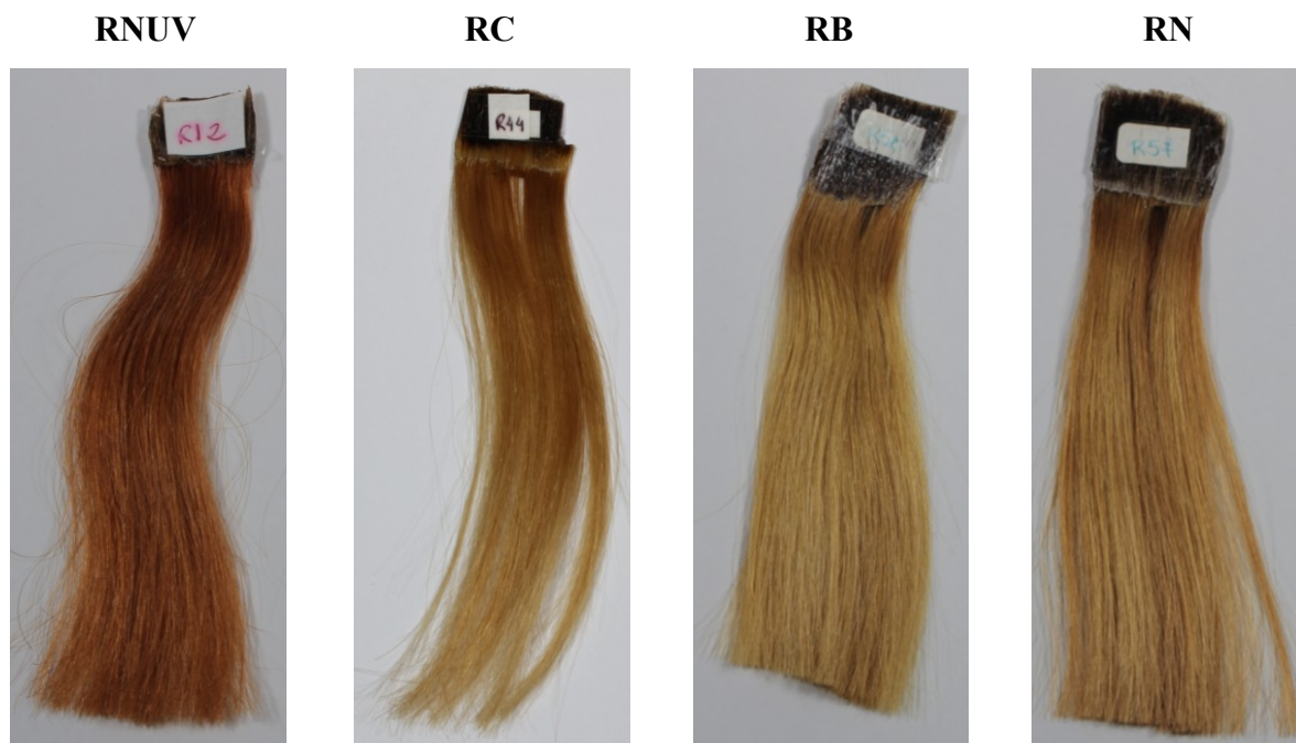
Figura 55. Imagens das mechas de cabelo tingidas de ruivo expostas ou não à radiação UV/Vis ( 500 \text{ W/m}^2 ) por 180 h
