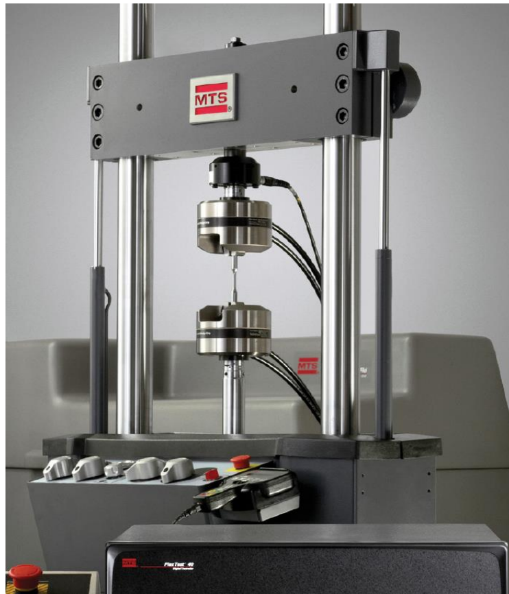
Figura 3.3 – Máquina servo-hidráulica MTS utilizada nos ensaios de fadiga oligocíclica na Universidade de Yanshan.
