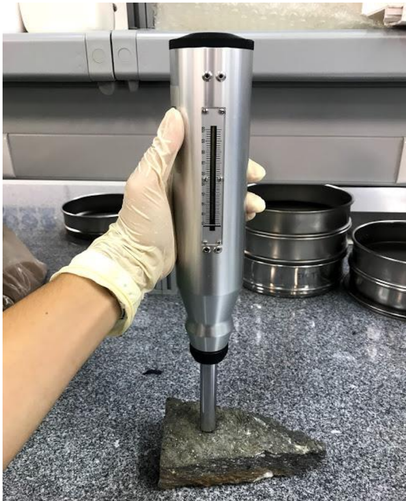
Figura 8 Leitor de unidade de pressão disponível no Martelo de Schmidt do Tipo L.
