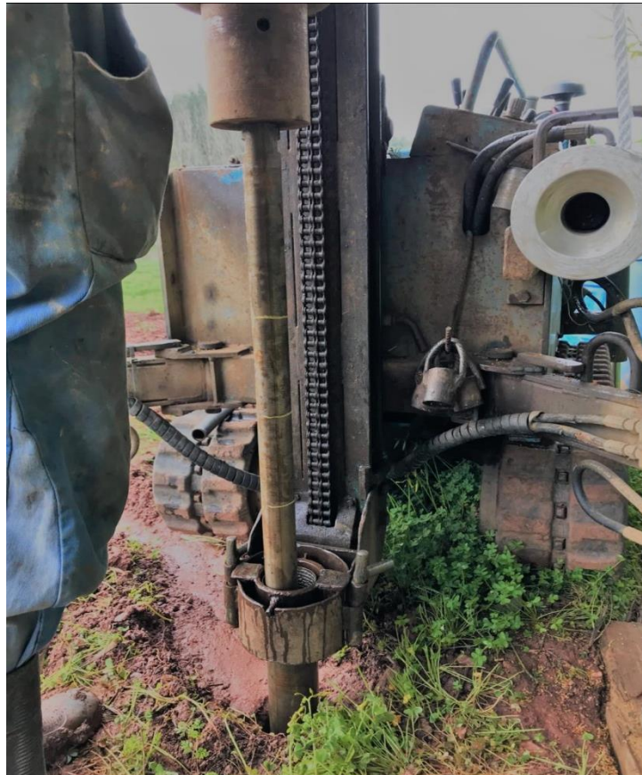
Figura 24- Ensaio SPT em execução.
