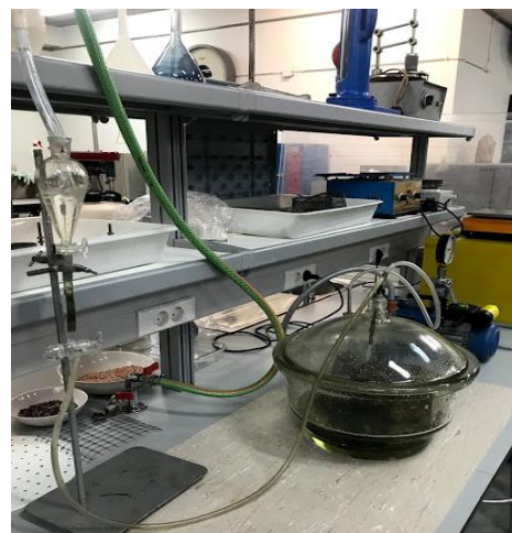
Figura 4- Montagem da bomba de vácuo
