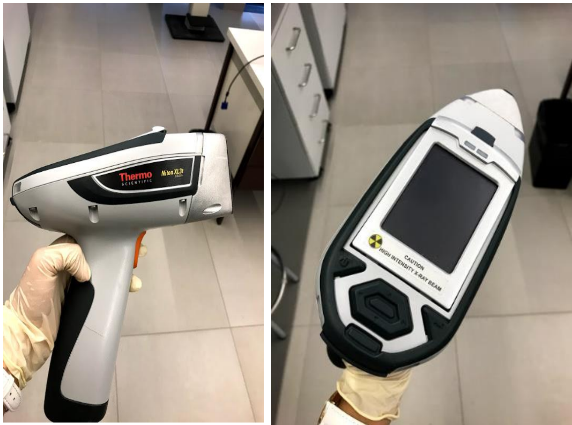
Figura 13- Niton XL3t XRF Analyzer utilizada para análise química das amostras.
