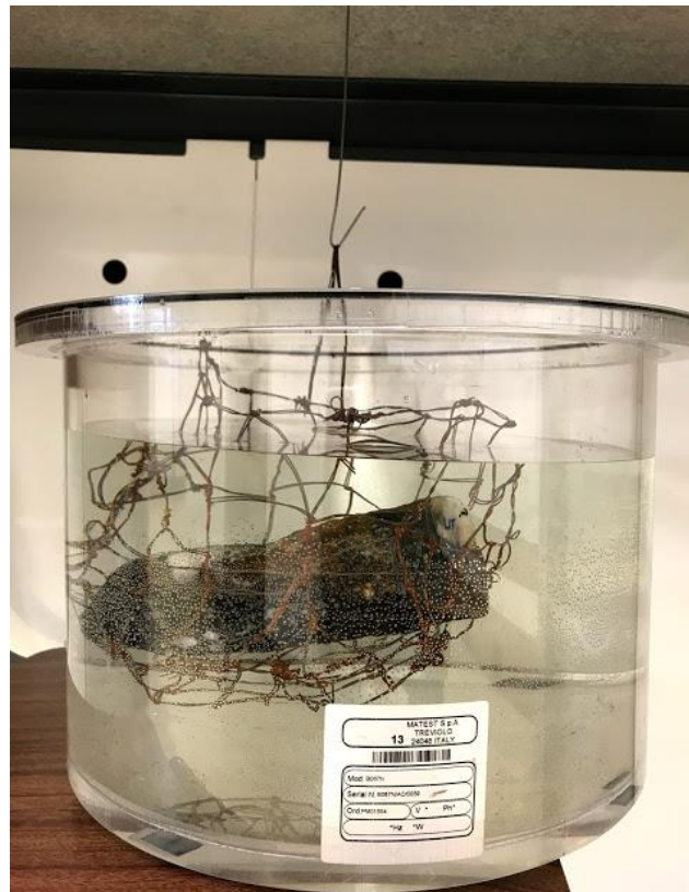
Figura 6- Pesagem da amostra submersa
