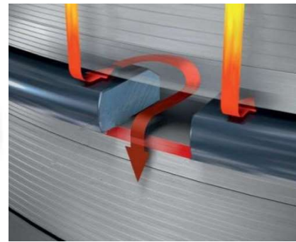
Figura 4.6 Fuga de gases para o cárter (Blow-By)
