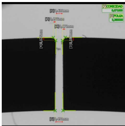
Figura 6.5 Exemplo de processamento de cota por visão artificial - KEYENCE
