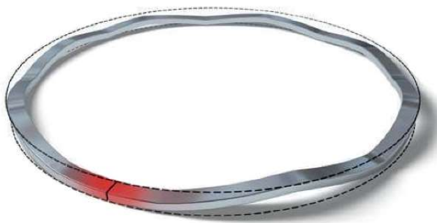
Figura 4.7 Pontas batem e anel deforma
