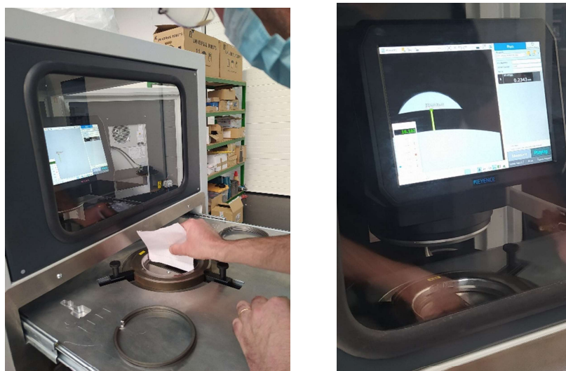
Figura 5.2 Medição de folga reduzida - KEYENCE
