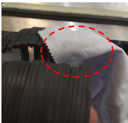
Figura 8.13 Sujidade entre passagens de estudo RR MID
