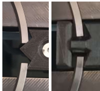
Figura 7.11 Pino extração perfil/chanfro a trocar anel com transferidor ferramental
