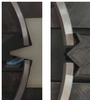
Figura 7.12 Anel posicionado em zona inspeção perfil/chanfro
