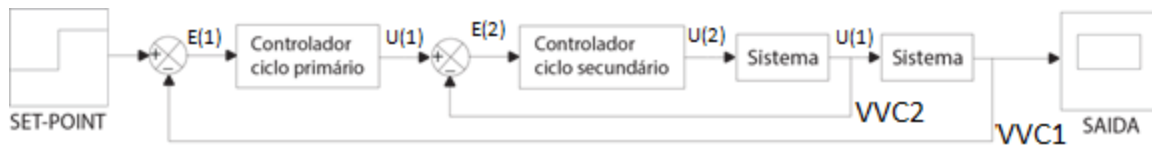
Figura 9 - Diagrama de blocos de um Sistema de controlo PID/PI/P em cascata de dois ciclos.
