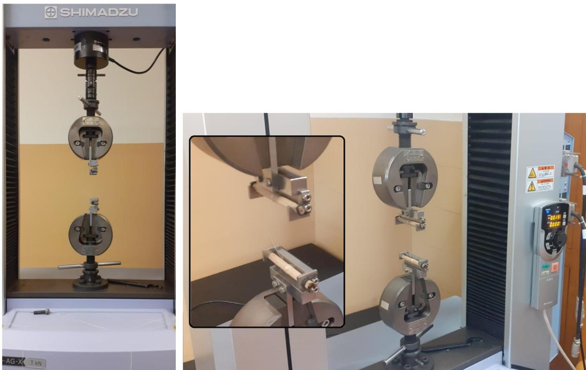
Figura A.1 – Equipamento SHIMADZU AG-X, célula de carga com capacidade para 5KN
