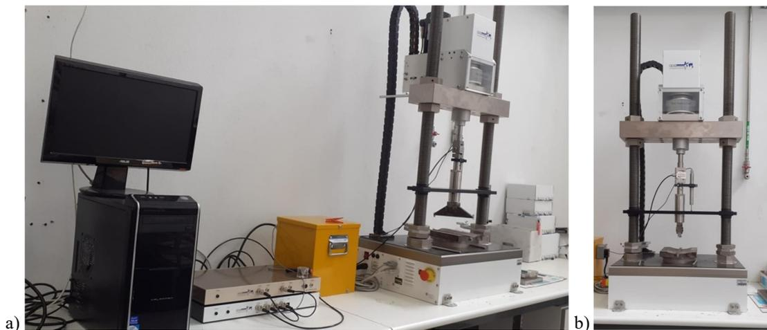
Figura 4.7 – Prensa ELDYN: a) Aparelhagem completa. b) Prensa (célula de carga com capacidade de 10 kN e 5 Hz)
