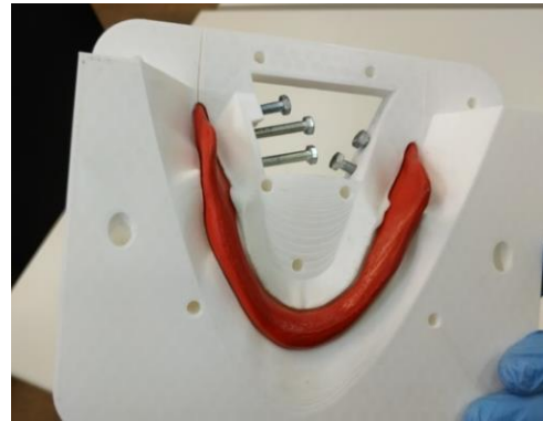
Figura 3.3. Modelo físico da parte trabecular inserido na segunda moldação (método 1).
