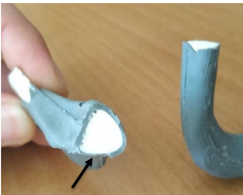
Figura 3.4. Zona de variação de espessura na parte cortical da mandíbula (método 1).
