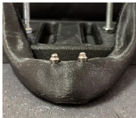
Figura 3.8. Implantes colocados na região anterior do protótipo mandibular.
