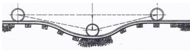
Figura 4.5 Nivelamento longitudinal da via (adaptado de Silva, 2006)
