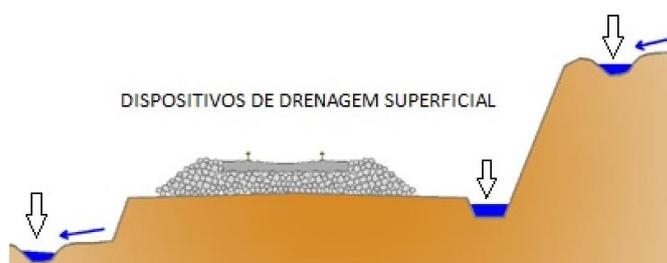
Figura 3.16 Captação de águas através dos dispositivos de drenagem superficial (adaptado de Tzanakakis, 2013)
