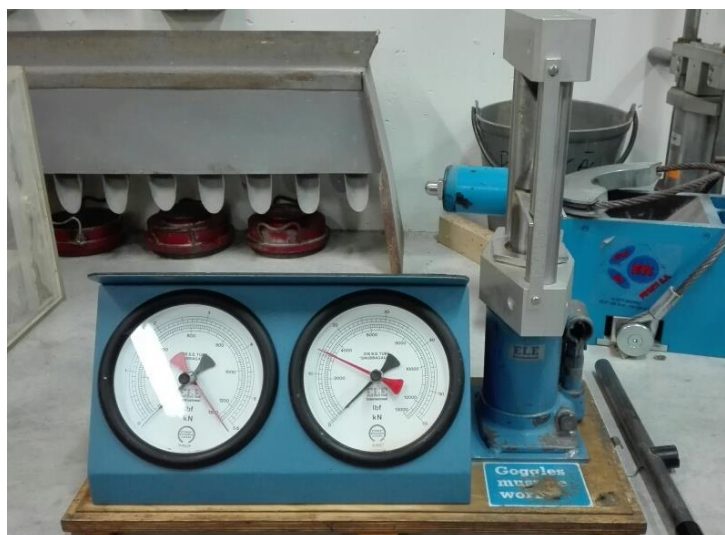
Fig. 3.3 – Dispositivo de ensaio para a concretização do ensaio de resistência à carga pontual
