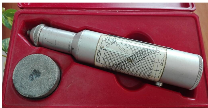
Fig. 2.13 – Martelo de Schmidt do tipo N usado nos ensaios
