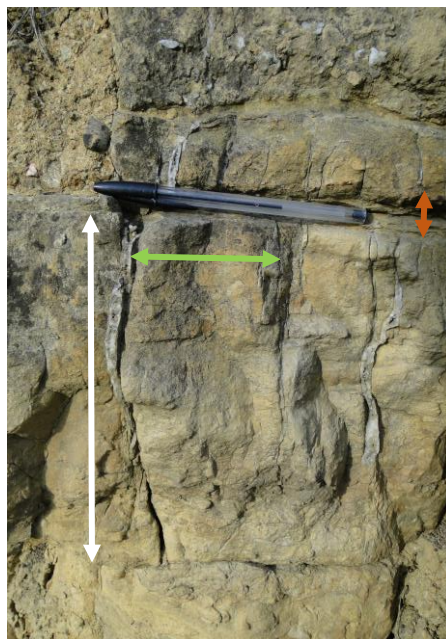
Fig. 2.9 – Representação esquemática do espaçamento (seta verde), da continuidade (seta branca) e da abertura (seta laranja)
