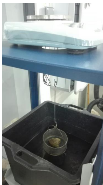
Fig. 3.2 – Procedimento para a determinação do peso submerso da amostra
