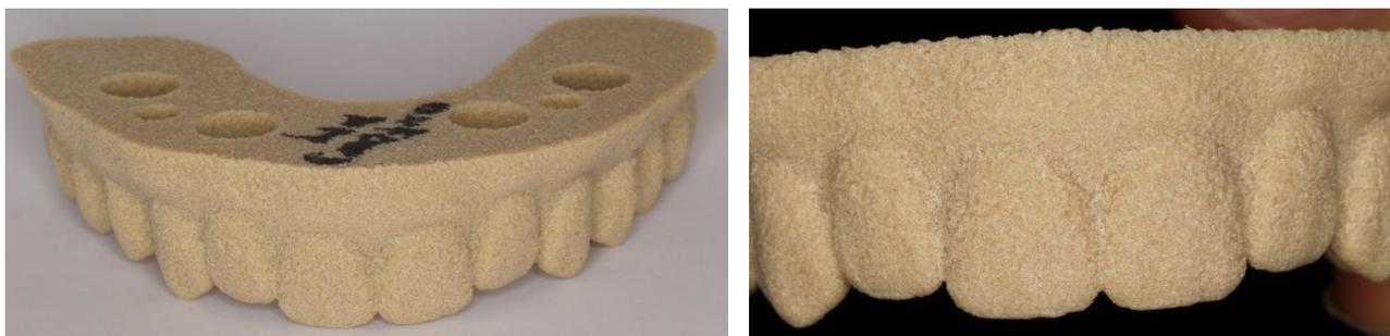
**Figura 3.9.** Arcada superior obtida por fabricação aditiva (SLM) a partir de pós de PEEK.
