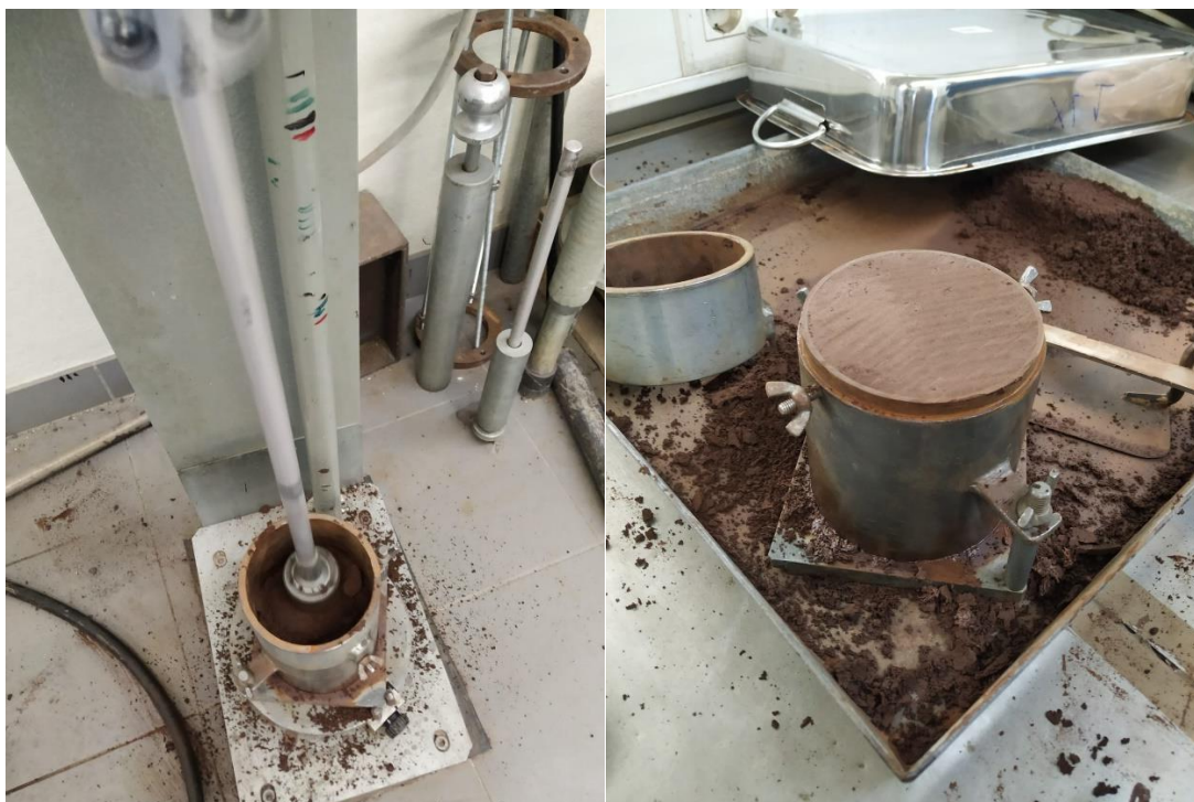
Figura 30 - Proctor Normal, ensaio automatizado e amostra final compactada.
