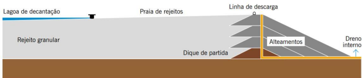
Figura 8 - Método de alateamento linha de centro (IBRAM, 2016)
