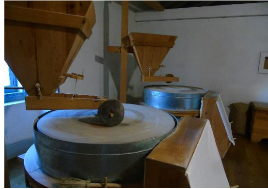
Figura 32 – Casais de mós a funcionar na sala de moagem a nascente
