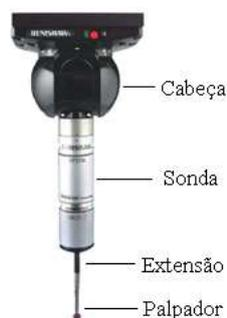
Figura 4.3 - Sistema de sondagem (Mitutoyo, n.d.).
