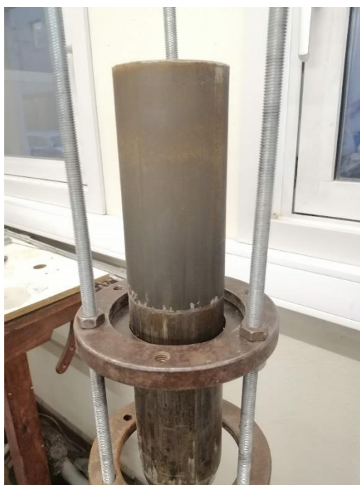
Figura 33 – Aspecto das amostras moldadas com auxílio de prensa e equipamento extrator
