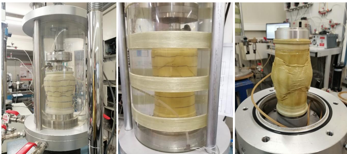
Figura 52 – Amostras densas com tensões de confinamento iguais a 20kPa (esquerda), 100kPa (centro) e 200kPa (direita) no final do corte
