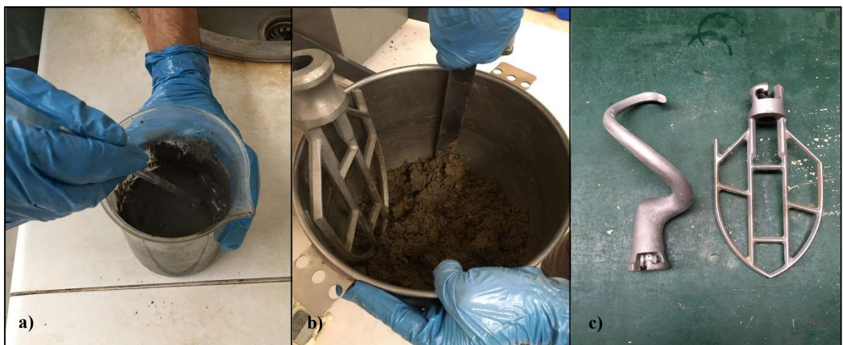
Figura 4.2 Etapas de preparação: a) Mistura do ligante cimentício com água; b) Remoção do compósito das paredes laterais da misturadora; c) Pás utilizadas: “rabo de porco”, para polipropileno; comum, para fibras de sisal e restantes misturas
