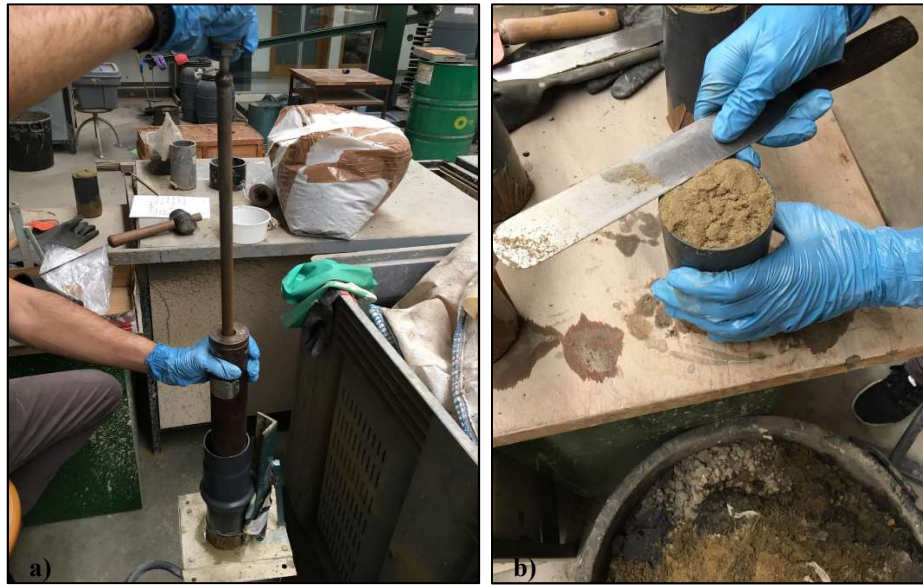
Figura 4.4 Etapas de moldagem: a) Compactação dos provetes; b) Retificação das amostras.
