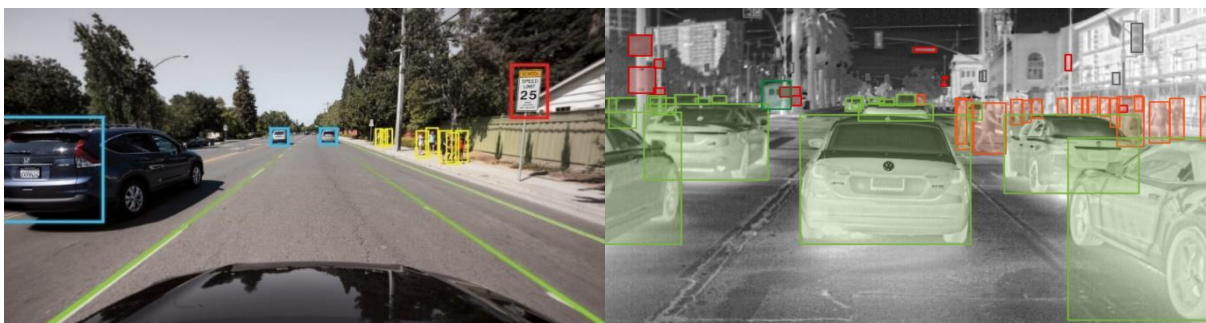
Figura 3.3 – Identificação de obstáculos por câmara convencional (Nvidia@2019) vs Identificação de obstáculos por câmara térmica (FLIR@2017).
