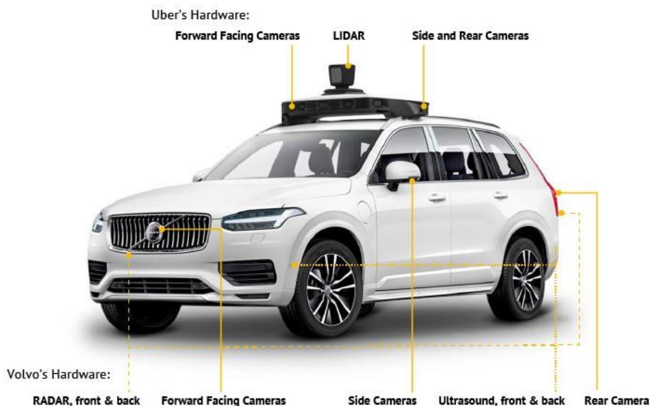
Figura 3.2 – Sensores usados num veículo de teste Volvo-Uber (Wevolver@2020).
