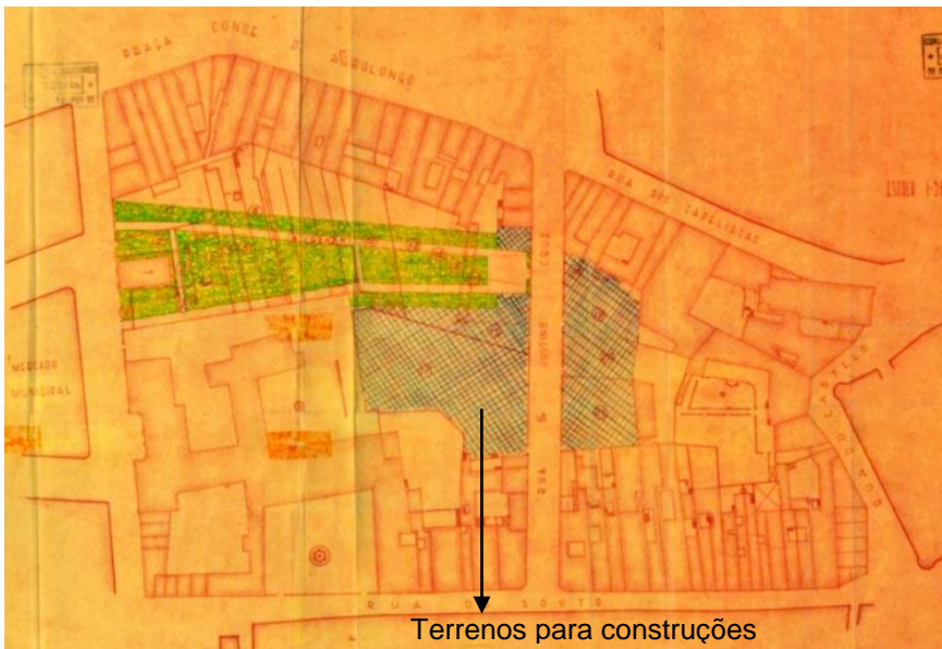
Figura 60 - Planta do Arranjo Parcial entre a Praça Conde de Agrolongo e a Rua do Souto (Demolição dos anexos no interior do quarteirão e desenho de largo arquitetural (do lado oeste)) esc. 1/500.
