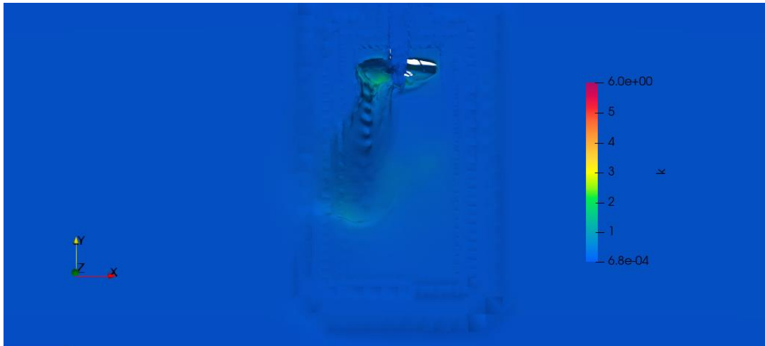
Figura 4.17- Entrada de ar na vala.
