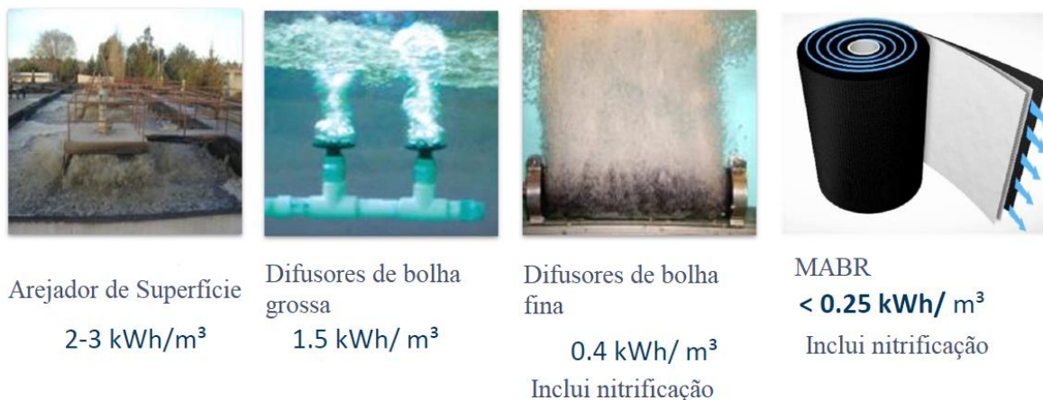
Figura 2.2- Consumo de energia pelos processos de arejamentos. Adaptado de CTGA ( Cornet, 2019).
