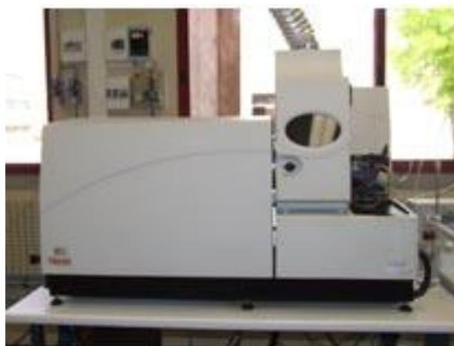
**Figura 27** – ICP-MS Thermo X Series do Laboratório Central de Análises da Universidade de Aveiro. (Fonte: LCA-UA)
