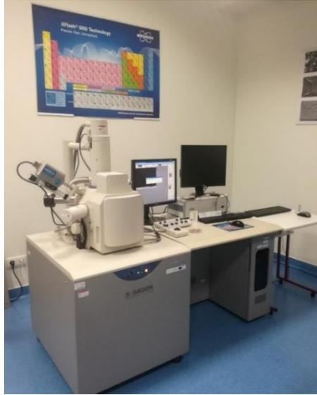
**Figura 21** – VP SEM Hitachi S - 3400N acoplado um detetor de EDX - XFLASH 5010, do Laboratório de Microscopia Eletrónica do CO-UBI.
