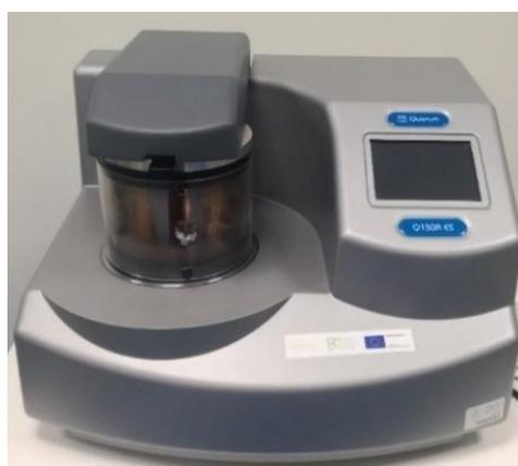
**Figura 23** – Equipamento usado para o revestimento com ouro das amostras, Q150R ES pertencente ao Laboratório de Microscopia Eletrónica do CO-UBI.
