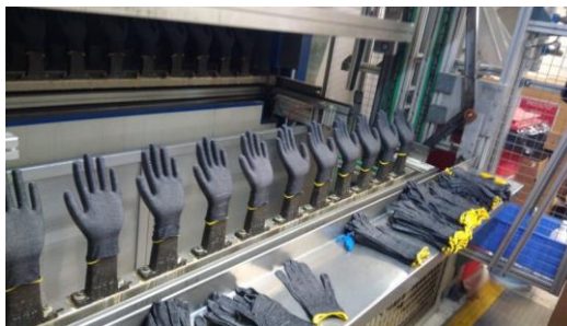
Figura A.3. Liners calçados nos moldes.
