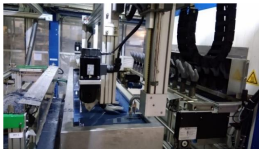
Figura A.7. Mergulho em tanque com o segundo revestimento.
