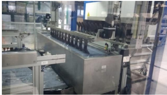
Figura A.6. Mergulho em tanque com o primeiro revestimento.
