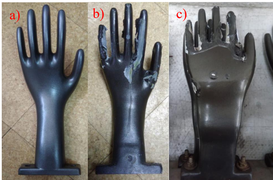
Figura 0.1. Molde novo (a), molde degradado (b), (c).
