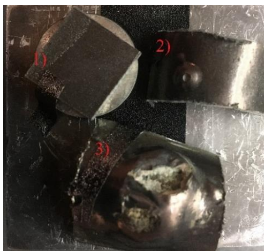
Figura 3.4. Moldes revestidos com PTFE: novo (1), pouco usado (2) e muito usado (3).
