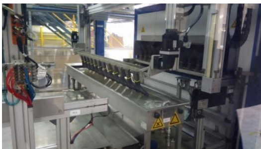
Figura A.4. Mergulho em tanque de ácido.
