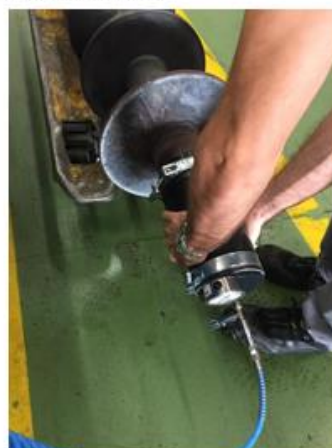
Figura 3- Colocar bocal na garganta da retorta.
