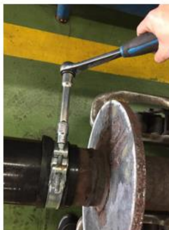
Figura 4 - Apertar o bocal.
