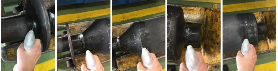
Figura 8 - Borrifar zonas de potenciais fugas.
