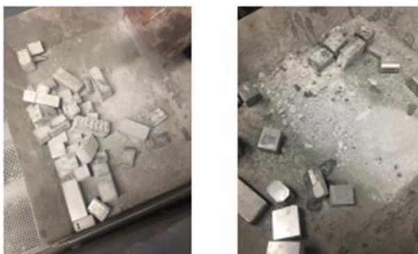
Figura 14 - Fragmentos e lixo que saiu após o teste, retorta 163 e 167, respetivamente.
