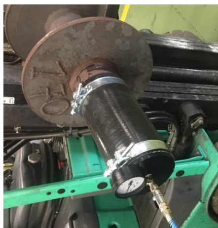
Figura 11 - Tampa de estanquicidade colocada na garganta da retorta.
