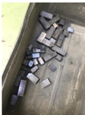
Figura 13 - Metal duro introduzido dentro da retorta para testar a eficácia da sua limpeza.
